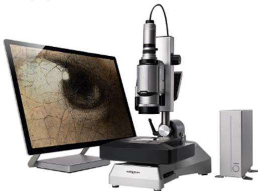
Le **NPS** est un système confocal de mesure 3D certifié ISO 25178-602. Dôté de capteurs à distance de travail et champs de mesure variables, il fonctionne par l'émission d'un faisceau de lumière blanche sur tout type d'échantillons, même transparent. Ce profilomètre permet des analyses et mesures sans contact avec une précision en Z au sous micron : volume, hauteur, surface, profil, rugosité, planéité, coplanarité, etc.
